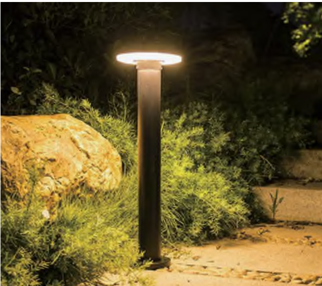
智能圆顶彩光草坪灯 产品型号：150702 电压/功率：24V dc / 12W 通信方式：PLC 灯光颜色：RGBWC 防护等级：IP65 外形尺寸：Φ180*600mm
