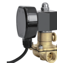
智能电磁水阀 产品型号：160201 电压/功率：24V d.c/20W 通信方式：PLC 水管接口：4分内牙 防护等级：IP65 外形尺寸：62*84*123mm
